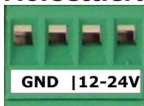
L'alimentazione del dispositivo avviene attraverso la batteria del mezzo sul quale lo si installa. La tensione di alimentazione può essere da 12 fino a 24Vcc. Sono stati predisposti 2 terminali per la massa (GND) e 2 terminali per il positivo (12-24V).
